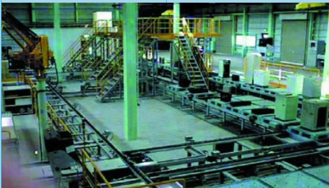
конвейер по демонтажу телевизоров
