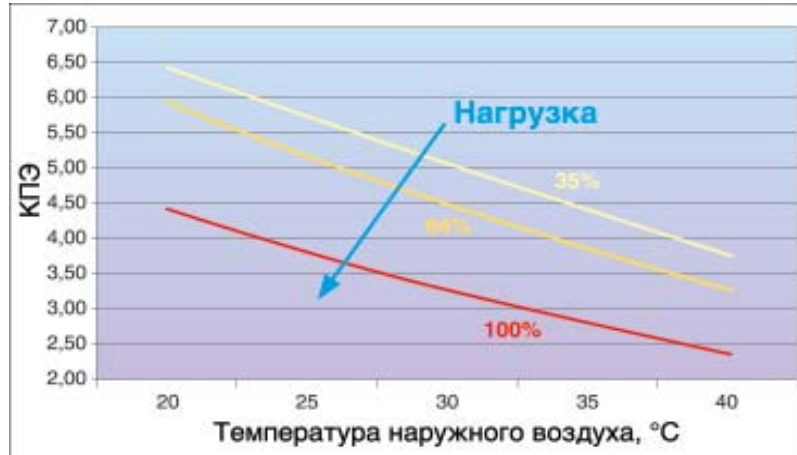
Рис. 9. Зависимость КПЭ от температуры наружного воздуха для чиллера Elfo Energy при работе с переменной нагрузкой
