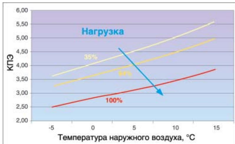
Рис. 10. Зависимость КПЭ от температуры наружного воздуха для чиллера Elfo Energy при работе с переменной нагрузкой в режиме обогрева
