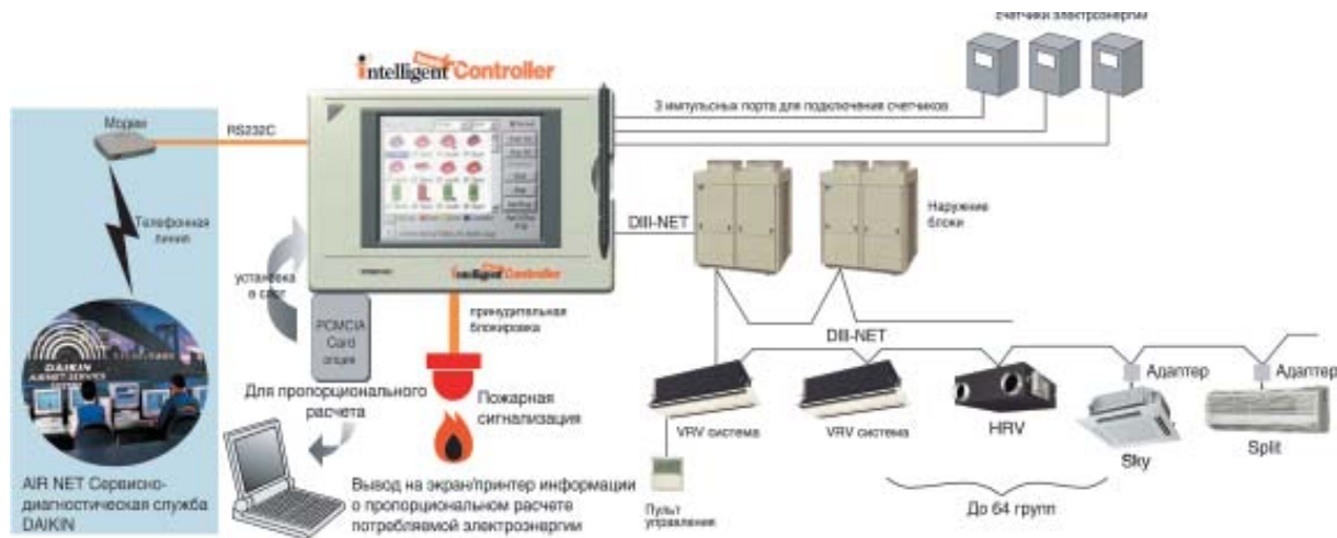
Рис.4. Схема объединения системы Intelligent Touch Controller с сервисно-диагностической службой DAIKIN
